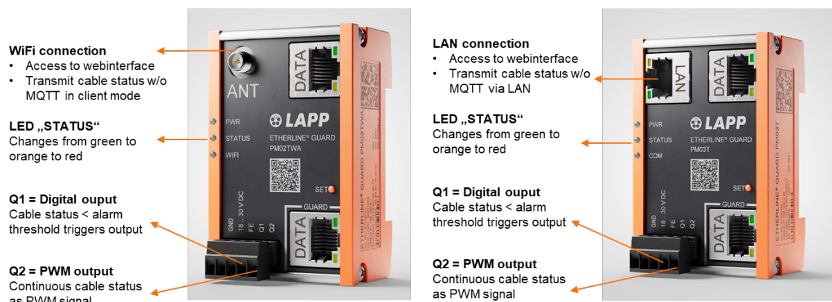
Abbildung 1: ETHERLINE® GUARD-Schnittstellen
