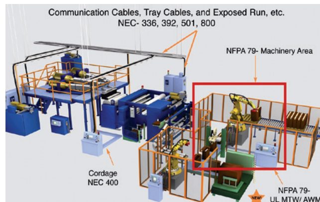
Dit schema van een industriële machine geeft de belangrijkste functies weer van draad en kabels m.b.t. de relevante paragrafen in NEC®/NFPA. "NEC®" is een handelsmerk van de National Fire Protection Association (NFPA).
