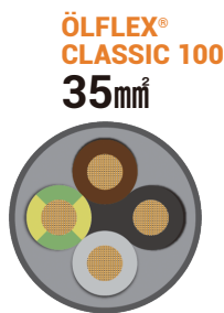
ÖLFLEX® CLASSIC 100 35mm φ 4G35 (35mm φ -4C) 許容電流:135A 耐電圧:4,000V
