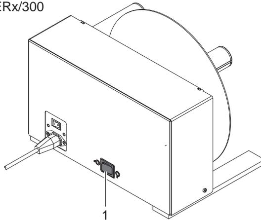
Bild 4 Auswahl der Wickelrichtung
