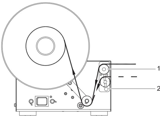
1. Umlenkachse (1) durch Drehen entgegen dem Uhrzeigersinn lösen.
