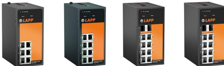
Dezentrale Verwendung - Kompakte Bauweise (Unmanaged)
